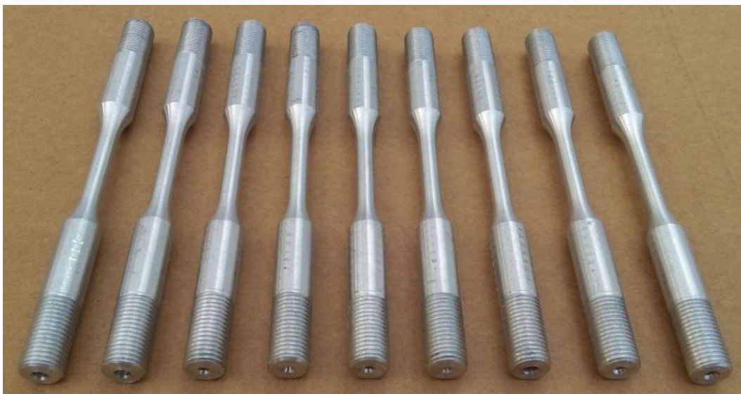
Слика 3.43. Епрувете за испитивање заморних карактеристика на повишеној температури - изглед прије испитивања
