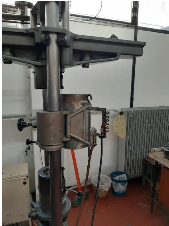
Слика 3.19. Универзална хидраулична машина за статичка испитивања - кидалица Amsler 200 kN
