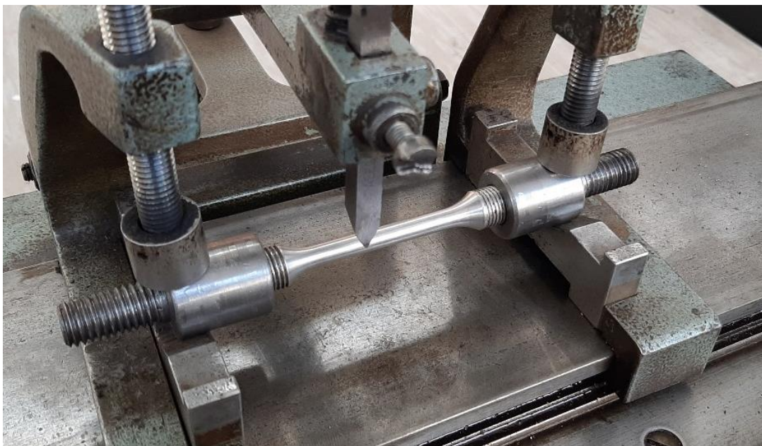
Слика 3.20. Обиљежавање епрувета прије теста с циљем утврђивања релативног издужења
