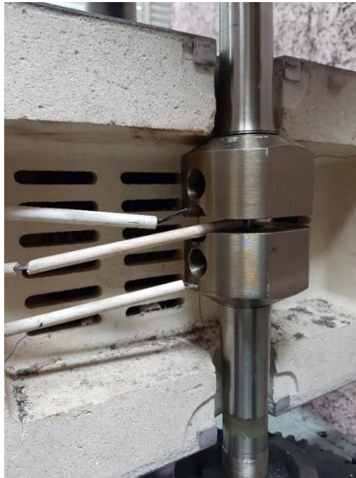
Слика 3.41. Постављање епрувете у комору за загријавање
