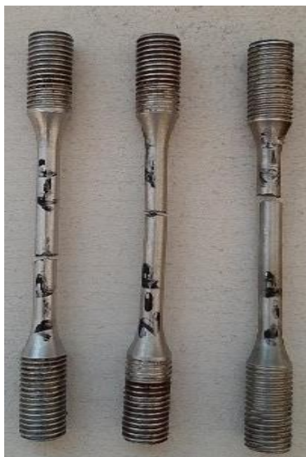
Слика 3.23. Епрувете за испитивање статичких карактеристика на повишеној температури - изглед након испитивања
