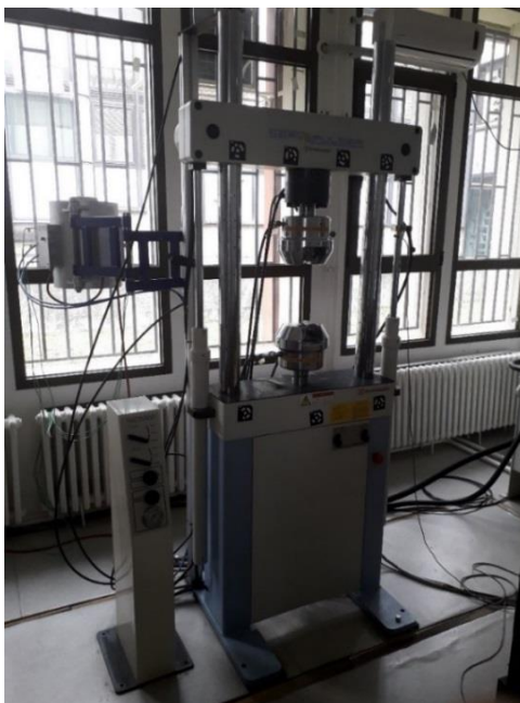
Слика 3.10. Сервохидраулични пулзатор/кидалица SHIMADZU EHF-EV101K3-070-0A
