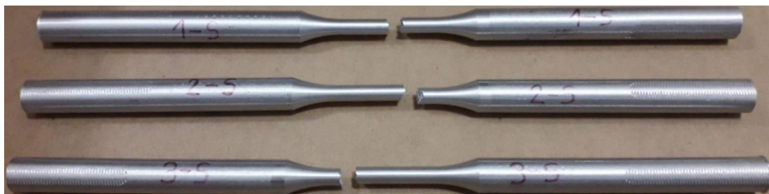
Слика 3.15. Округле епрувете за испитивање статичких карактеристика на собној температури - изглед након испитивања
