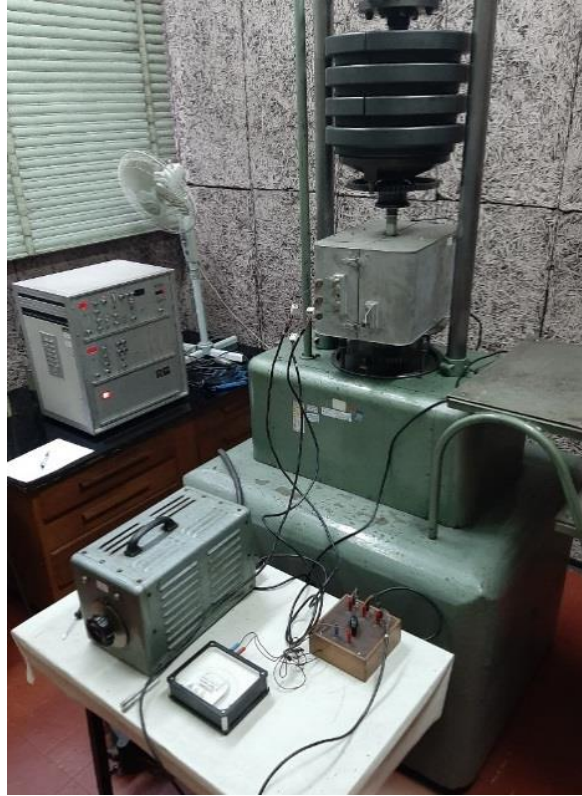
Слика 3.40. Поступак испитивања заморних карактеристика материјала на повишеној температури
