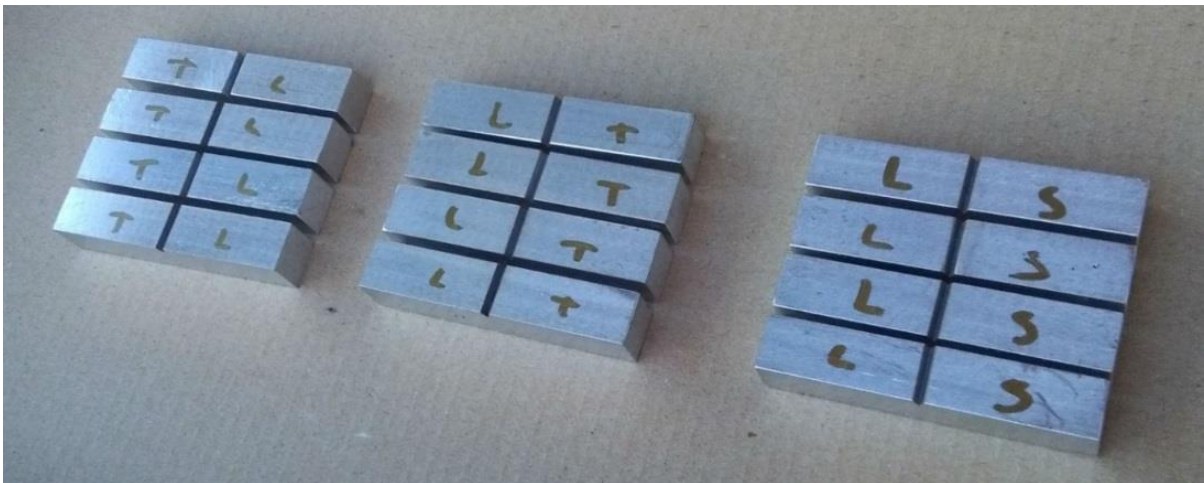
Слика 3.28. Епрувете за испитивање ударне жилавости - правци вађења епрувета из припремка
