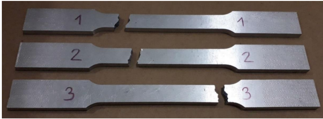
Слика 3.16. Равне епрувете за испитивање статичких карактеристика на собној температури - изглед након испитивања
