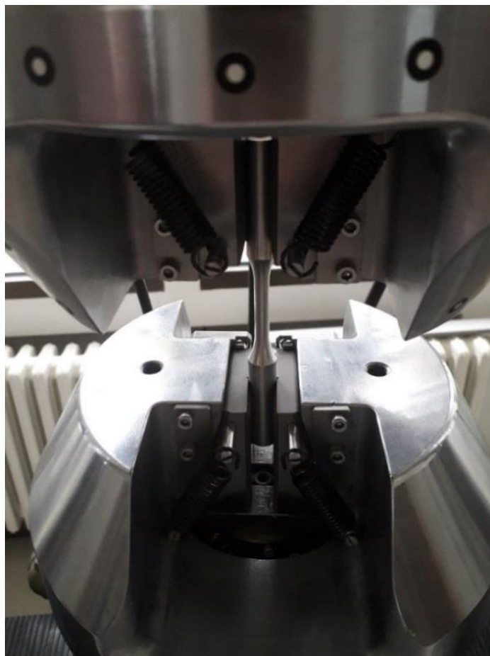
Слика 3.37. Поступак испитивања заморних карактеристика материјала на собној ( 23 \pm 5^\circ\text{C} ) температури
