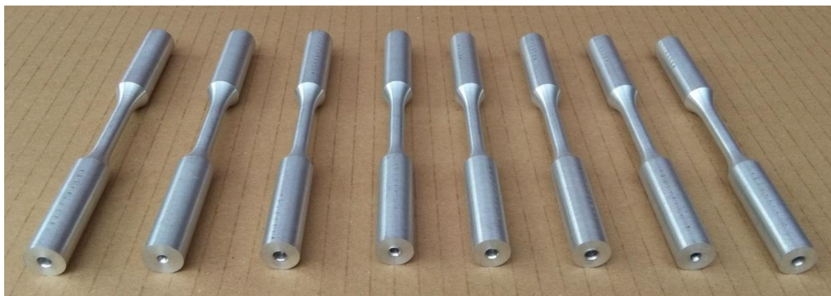
Слика 3.38. Епрувете за испитивање заморних карактеристика на собној температури - изглед прије испитивања
