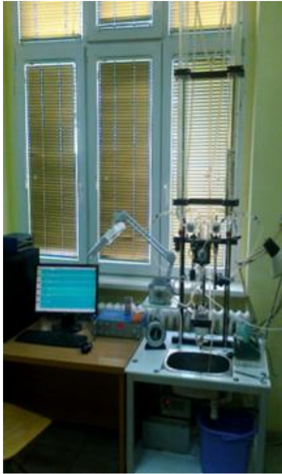
Слика бр. 7. Модификовани апарат по Langendorff-у (LF-11-LF01 F-P, Perfusion systems for isolated, small mammalian hearts according to Langendorff, Experimetria LTD Budapest, Hungary)
