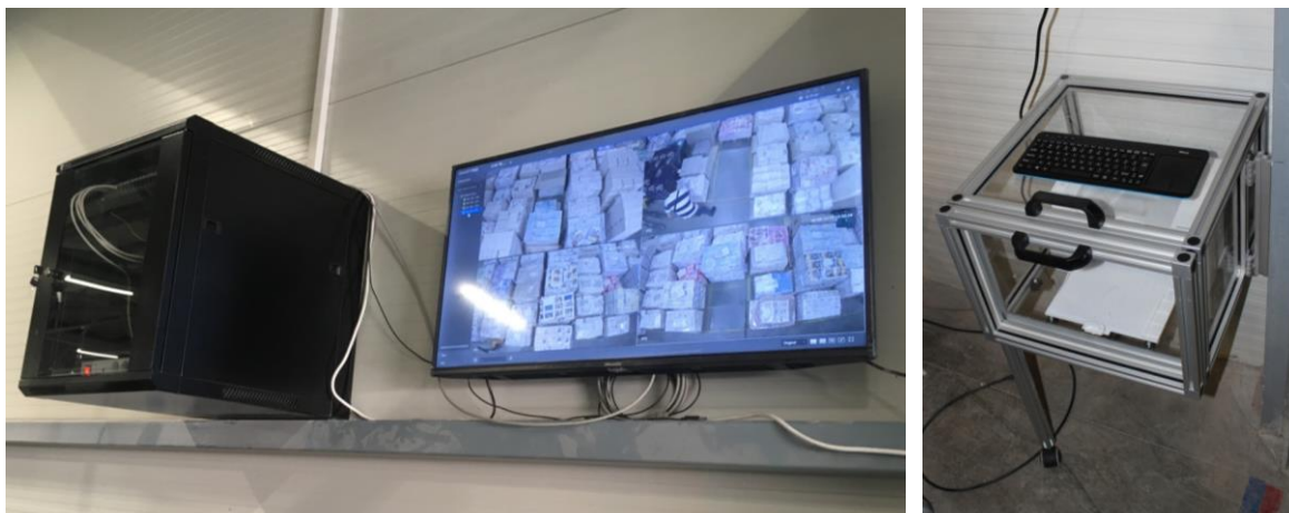
Слика 5.12 Изглед имплементираниог решења (мини-серверска станица повезана са IP камерама, монитор великих димензија тако да се види са удаљености у производном погону, и десно – штампач QR кодова са енгл. Touch pad тастатуром).
