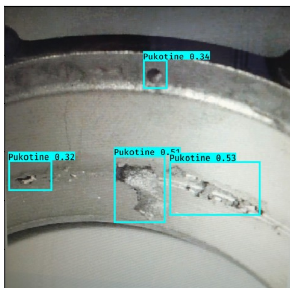
Слика 4.58. Неусаглашеност класе пукотина Слика 4.59. Неусаглашеност класе Мехур
