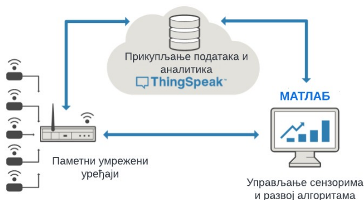
Слика 4.41. Пример рада Матлаба у спрези са ThingSpeak платформом
