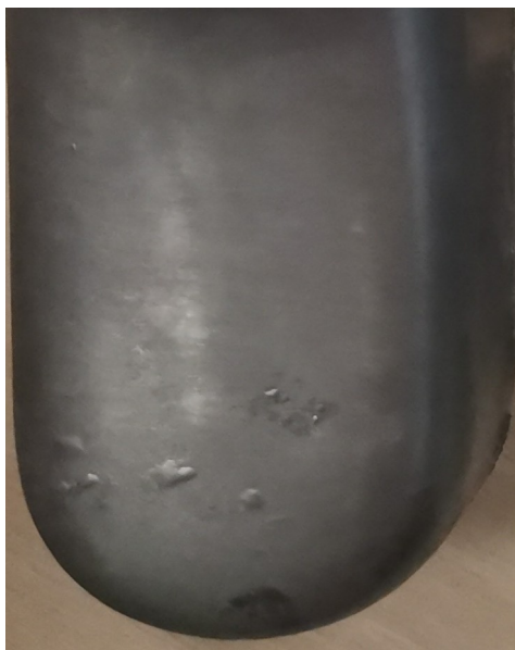
Слика 4.36. Неусаглашен полупроизвод класе мехур
