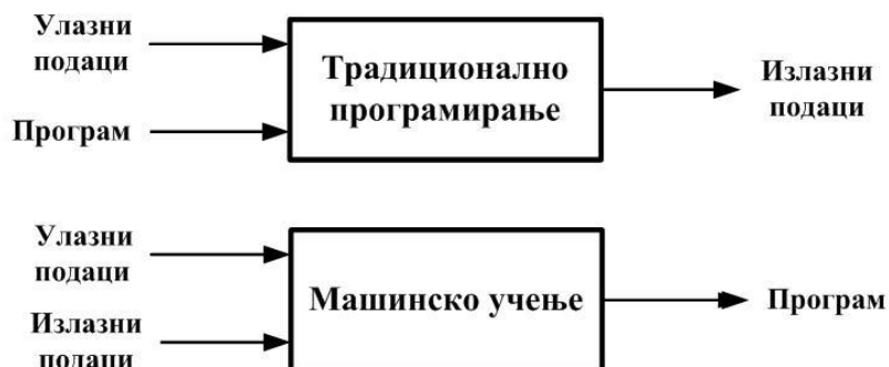
Слика 12. Поређење (а) традиционалног програмирања и(б) машинског учења
