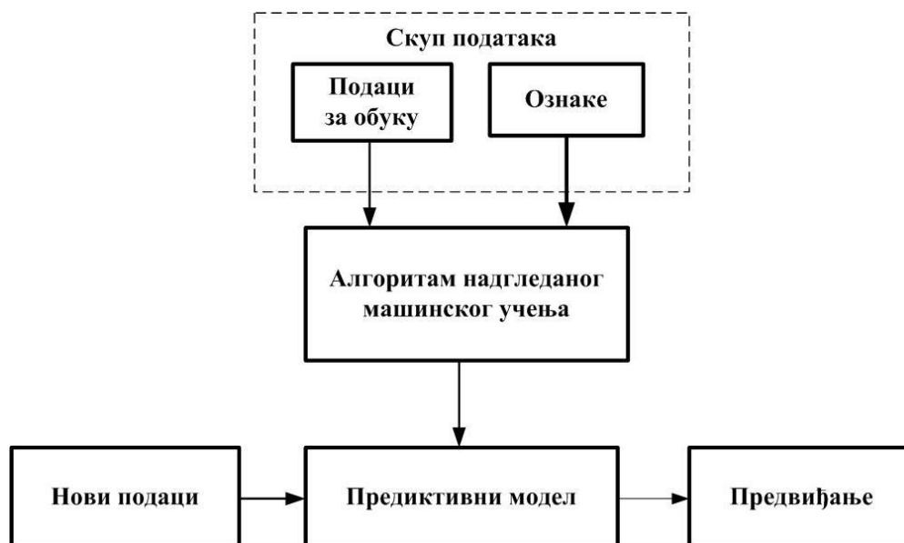
Слика 14. Процес изградње предиктивног модела код надгледаног машинског учења
