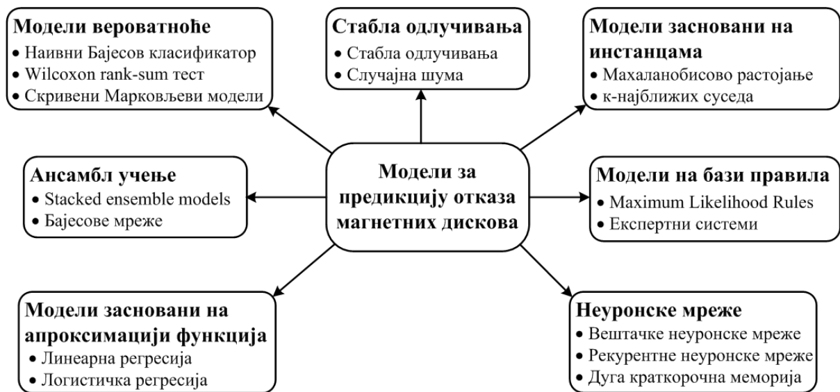
Слика 22. Класификација алгоритама машинског учења за предвиђање отказа [63]
