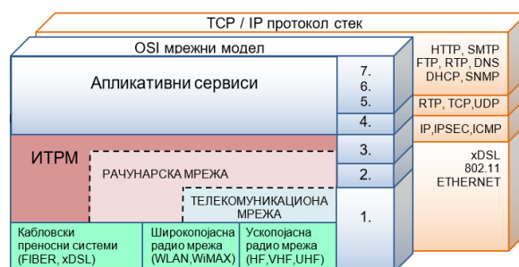
Слика 17. OSI мрежни модел и TCP/IP протокол стек за избор технологије и технике комуникационе структуре ИТРМ
