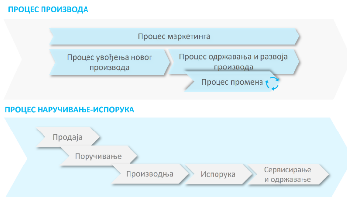
Слика 1. Структура процеса животног циклуса производа [193]
