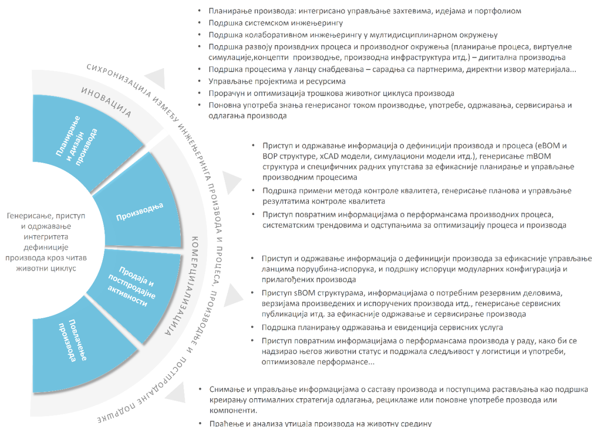
Слика 8. Улога PLM система кроз фазе животног циклуса производа
