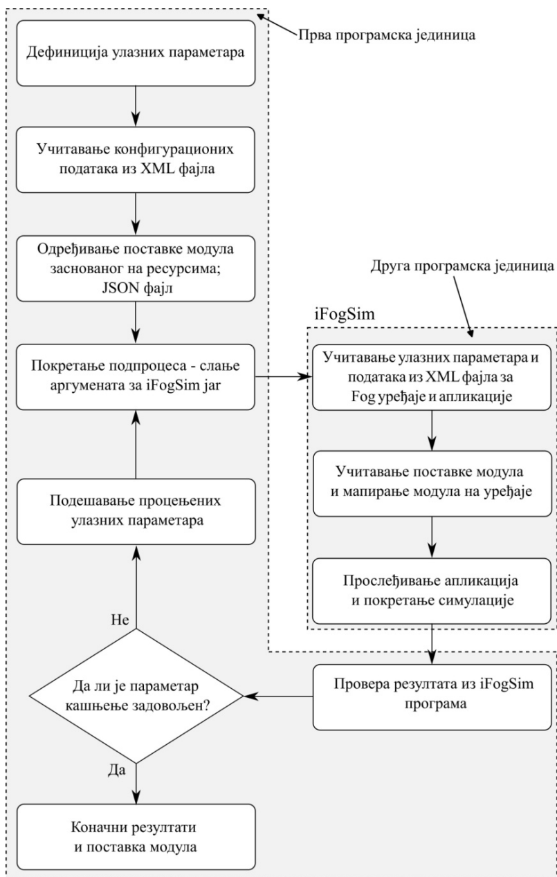
Слика 33. Блок шема проналажења максималног броја крајњих уређаја за очекивано кашњење
