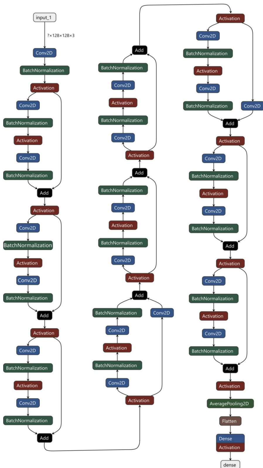
Слика 22. Блок дијаграм реализованог класификационог модела
