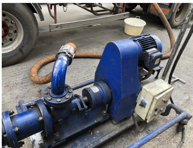
Слика 4.14 Монопумпа за истакање аутоцистерни
