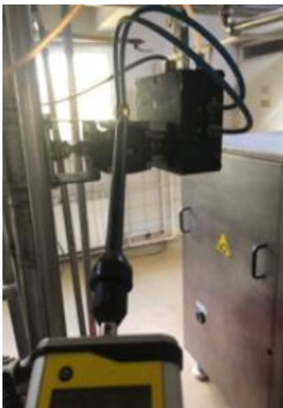
Слика 4.45 Детекција цурења компримованог ваздуха
