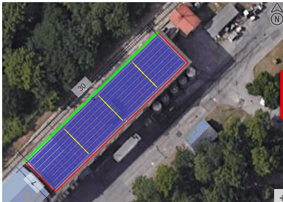
Слика 4.48 Предложен распоред и груписање фотонапонских панела
