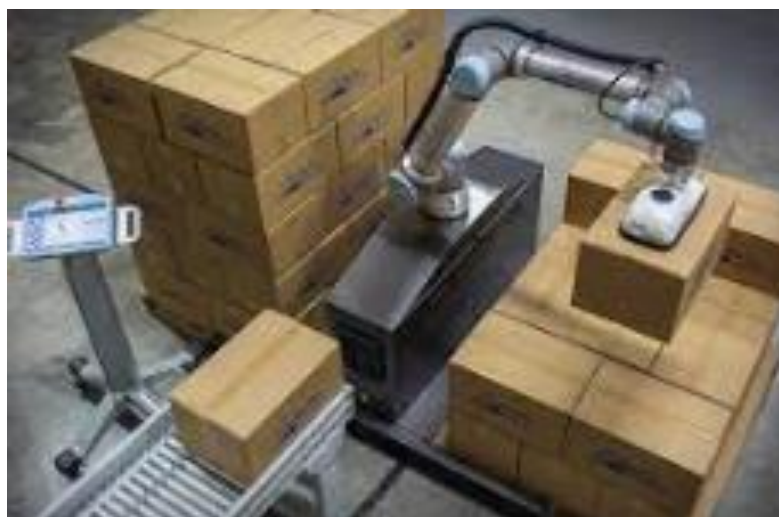
Слика 4.44 Предлог примене кобота за палетизирање збирних паковања индустријског маргарина и биљних масти (Industry USA , 2020)
