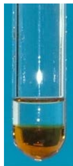
Слика 33. Бифазна смеша јонска течност – паладијум каталитички систем (доњи слој) и диетил-етар/хексан (горњи слој).
