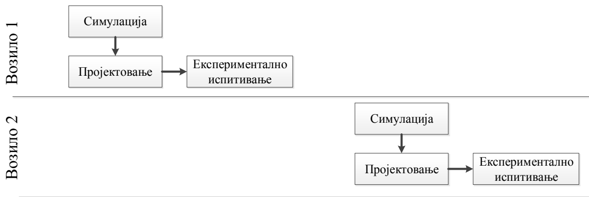
Слика 2-6. Тренутно место симулације понашања возила у пројектовању железничких возила
