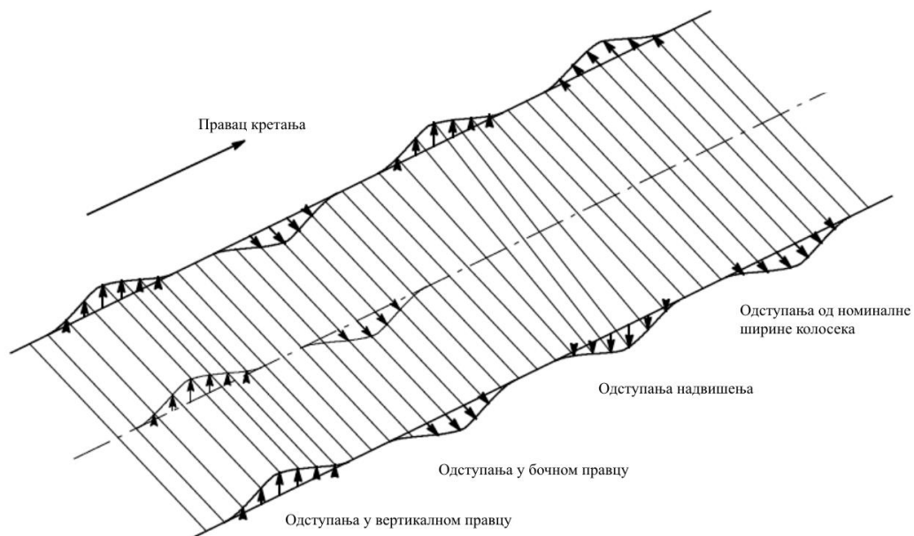
Слика 5-24. Неправилности на колосеку
