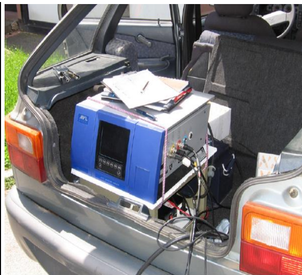
Слика 3.13 Уређај AVL DiCom 4000 на терену
