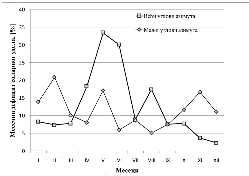
Слика 9.53 - Месечни дефицит соларног удела, за одступања угла азимута |\gamma - \gamma_{opt}| = 22.5^\circ , добијених оптимизацијом f_i(\beta_i = \beta_{a,opt}, \gamma_i) , тј. када је \beta_i = \beta_{m,opt} = \beta_{a,opt} = 37.5^\circ , за соларни систем за загревање СТВ са СК#12
