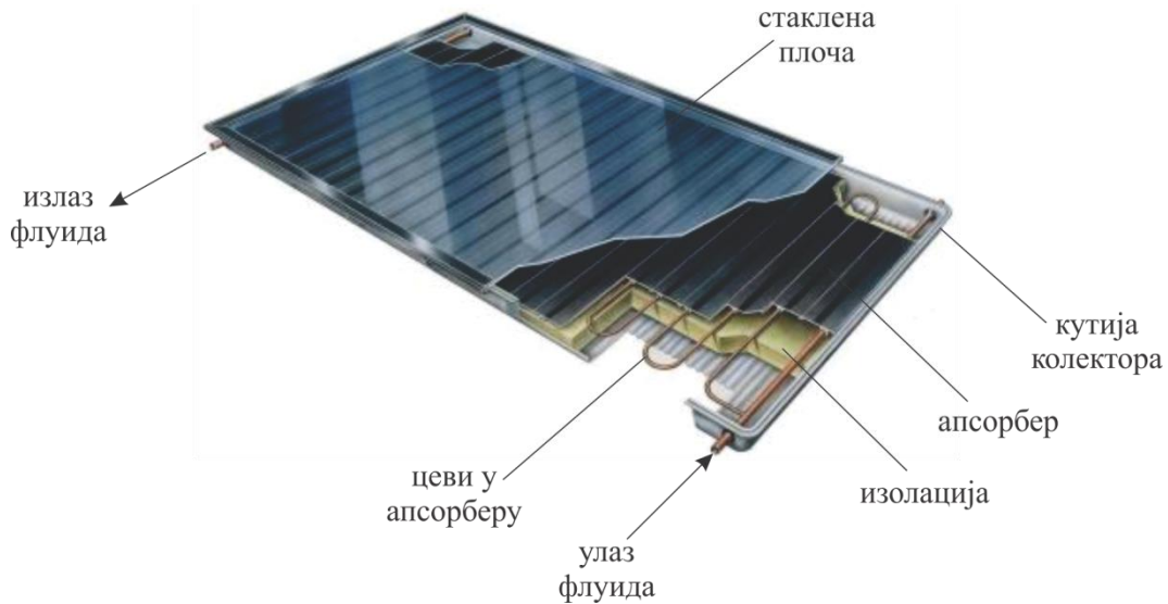
Слика 3.5 - Равни водени соларни колектор
