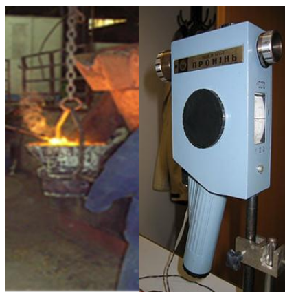
Слика 7.19 мерење температуре лива оптичким пирометром[115,117]
