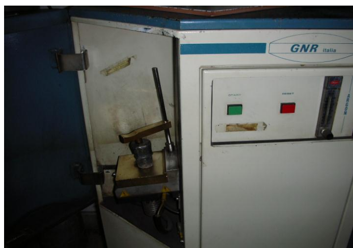
Слика 7.8 Спектрохемијска анализа хемијског састава узоркованих кугли: изглед спектрохемијског уређаја и место постављања узорка за анализу
