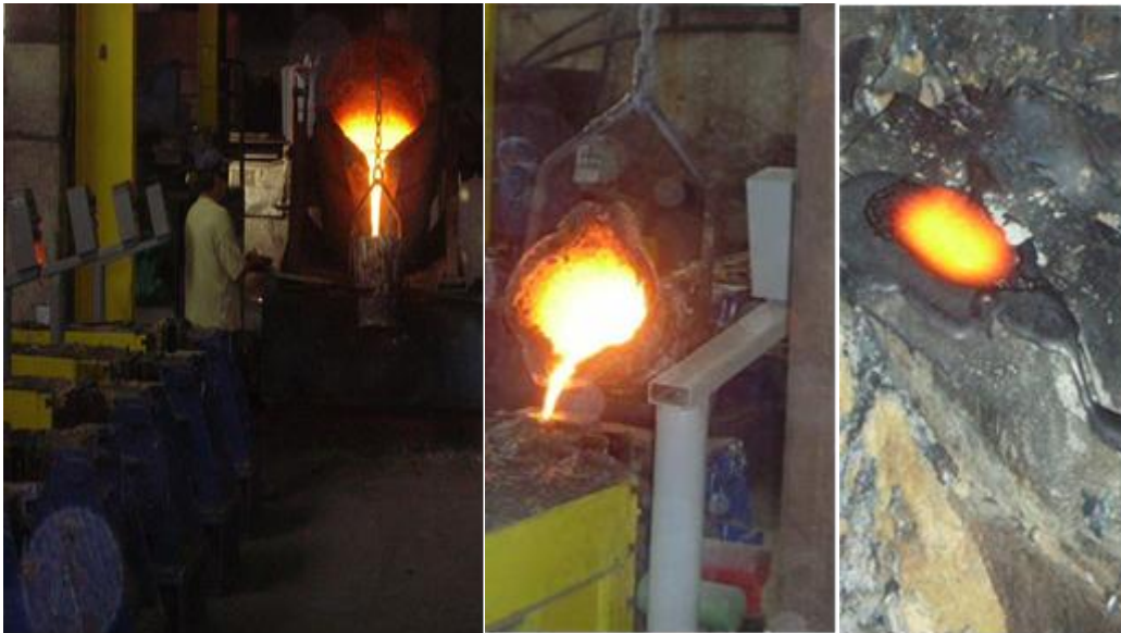
Слика 7.22 Поступак ливења флотационих кугли у процесу извођења експеримента
