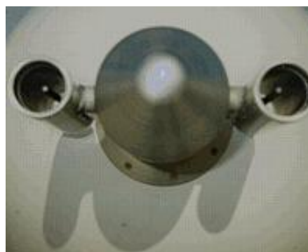
Слика 3.15. Сонде за мерење електричне проводности атмосфере
