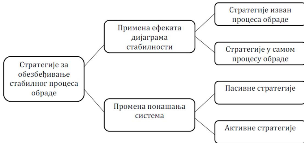
Слика 2.19. Стратегије за обезбеђење стабилног процеса обраде [29]
