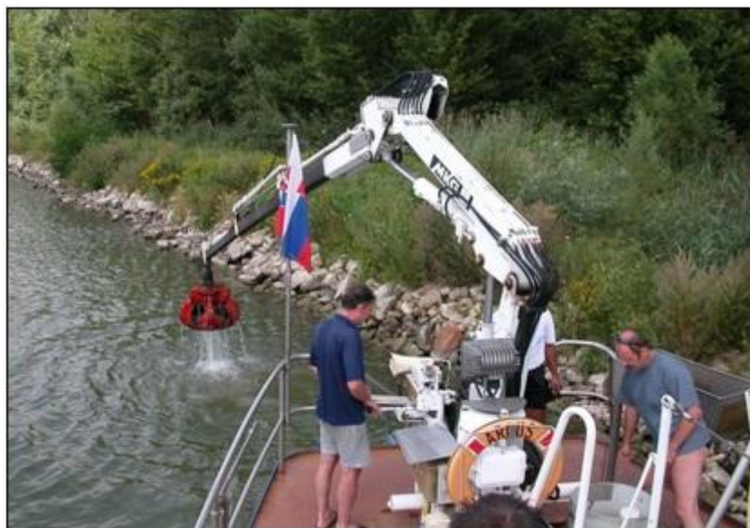
Слика 8. Узорковање хидрауличним polyp багером са истраживачког брода Аргус, преузето и прилагођено према Рауновић, 2007.
