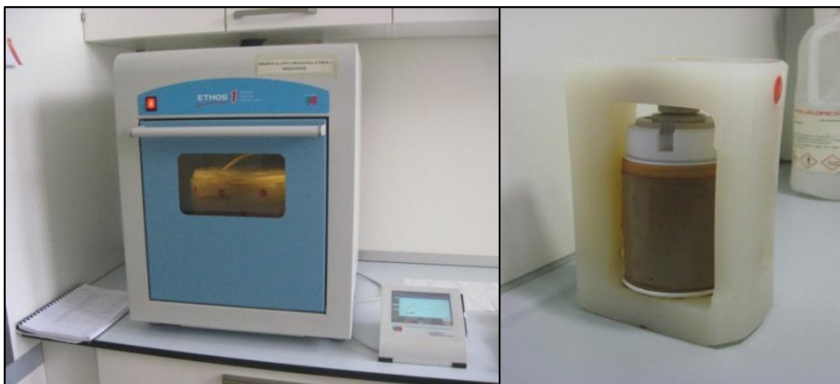
Слика 5. Микроталасна пећ (ETHOS 1, Advanced Microwave Digestion System, MILESTONE, Italy), лево и дигестациона „бомба“, десно. Фото: А. Милошковић
