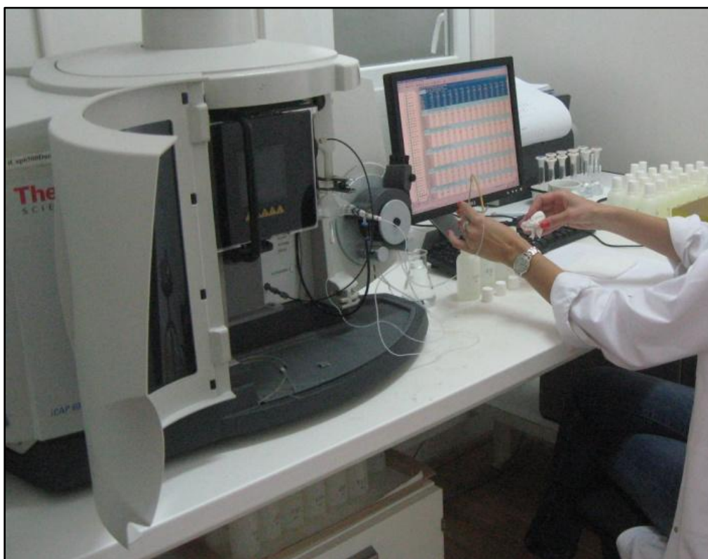
Слика 7. Апарат за индуктивно купловану плазму - оптичко емисиону спектрометрију (ICP-OES, Thermo Scientific iCAP 6500 Duo ICP, Thermo Fisher Scientific, Cambridge, United Kingdom). Фото: З. Александровић
