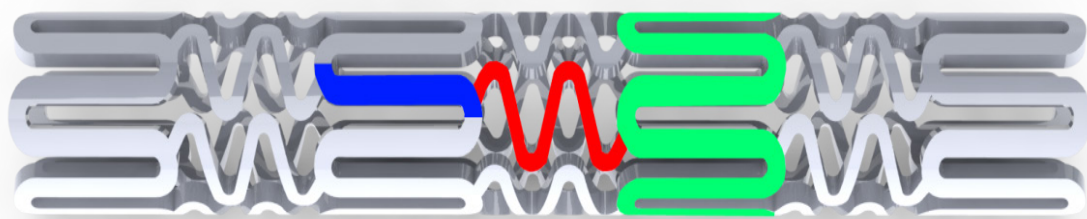
Слика 2.3 Основни делови стента: плавом бојом обележени су штапови (енгл. Strut) који чине прстен стента (означено зеленом бојом) док је црвеном бојом приказан мост (енгл. Bridge);
