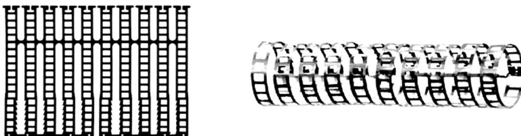
Слика 3.24 „Navius ZR1“ стент израђен од нерђајућег челика
