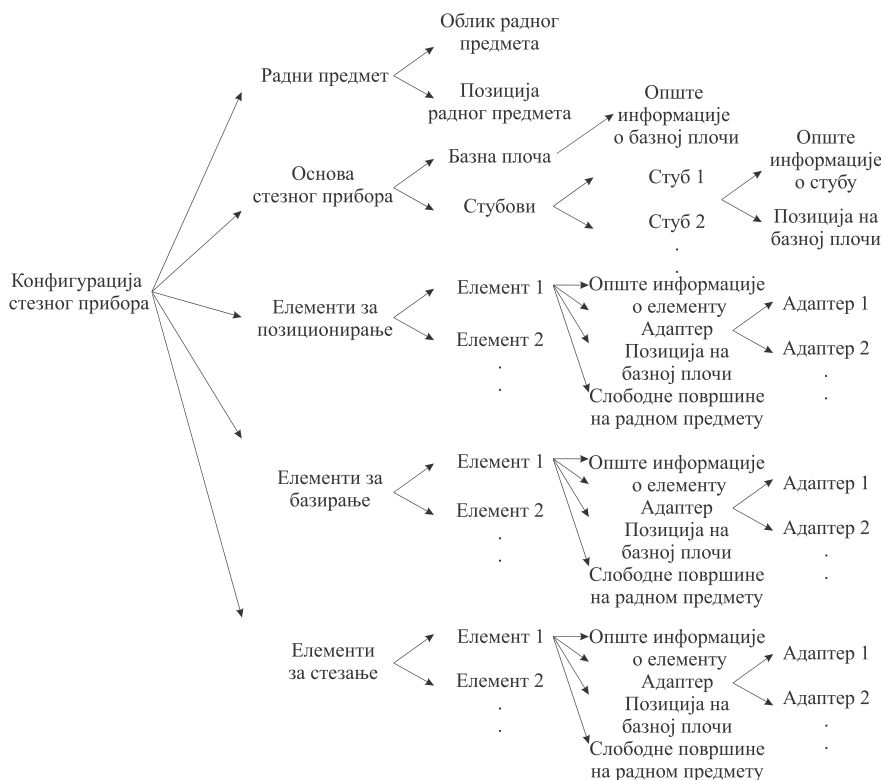
Слика 2.1 Структурна шема стезног прибора [21]
