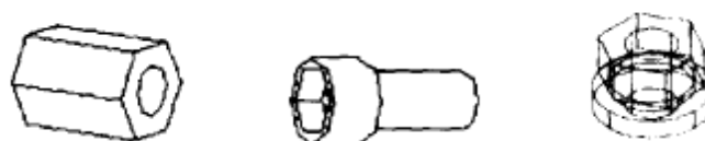
Слика 3.8 Елементи модуларног стезног прибора са основом базирања преко отвора
